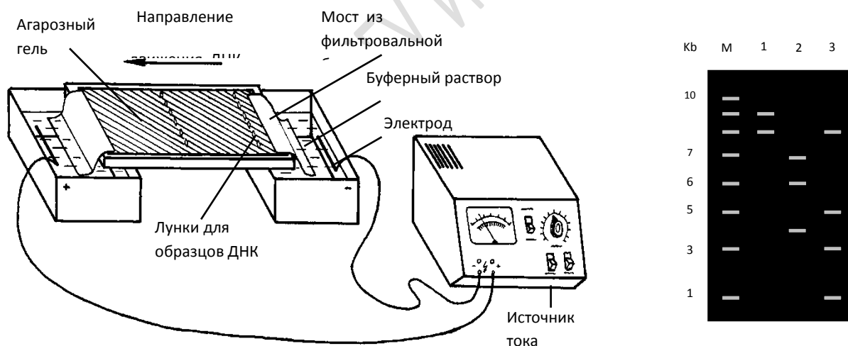
Рисунок 110. Схематическое изображение камеры для электрофореза ДНК в агарозном геле. Справа представлена электрофореграмма фрагментов ДНК, окрашенная этидиум бромидом и помещенная под УФ свет. (М – маркеры, 1,2,3 – образцы одной и той же ДНК, разрезанные различными рестриктазами).
