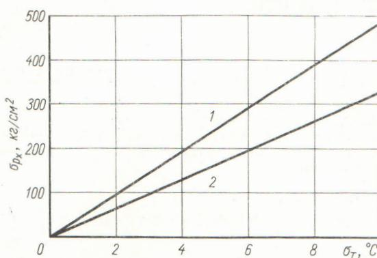
Рис. 1. Зависимость интенсивности термических напряжений от интенсивности пульсаций температуры на поверхности пластины с защемленными (1) и свободными (2) краями.
