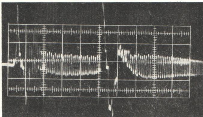
Рис. 1. Осциллограмма сигнала с индукционных электродов при многооборотной инжекции без ускорения.
