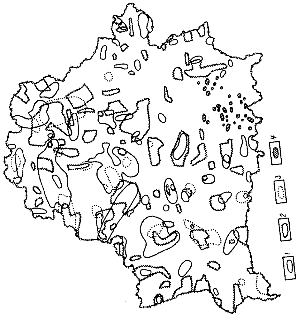
Рис. 16. Карта неотектонических элементов, проявляющихся в строении антропогенного покрова и рельефа (по результатам корреляционного анализа): блоки фундамента, выраженные в кровле (1), особенностях разреза (2) и подошве (3) антропогенного покрова, локальные положительные в рельефе структуры (4), выраженные в
