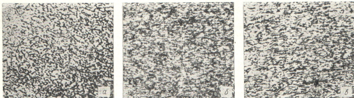
Р и с. 3. Микроструктуры сплава циркония с 2,5% ниобия:
