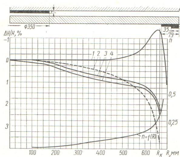
Зависимость формы напряженности магнитного поля от радиуса при различных  $H_0$ :
