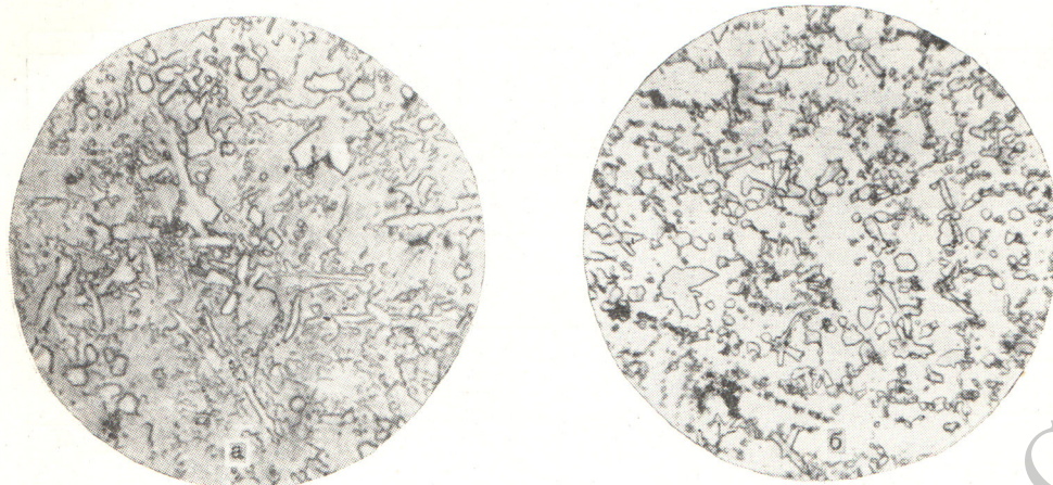
Р и с. 6. Структура плавки 8 с 3,5% бора, 9,25% титана (увеличение 600):
