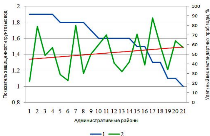
Рис. 4. Связь между значениями показателя защищенности грунтовых вод (1) и удельным весом нестандартных проб воды в колодцах (2) на территории административных районов Гомельской области (номер административного района соответствует порядковому номеру района в табл. 1)
