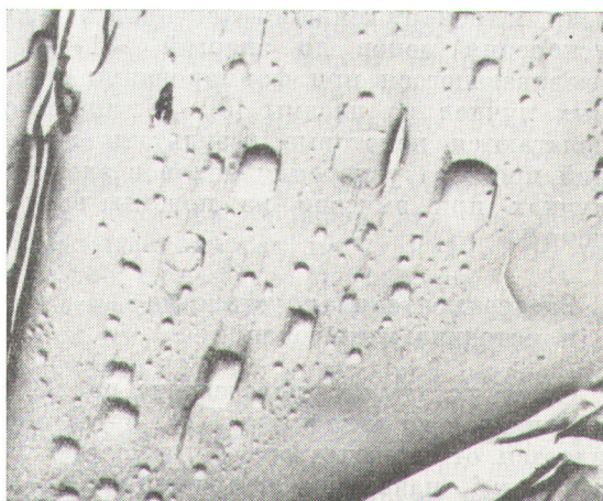
Рис. 2. Угольная реплика со скола BeO, облученной до 7 \cdot 10^{20} см -2 и отожженной при температуре 1500°С в течение 2 мин 45 сек ( \times 10\,000 ).
