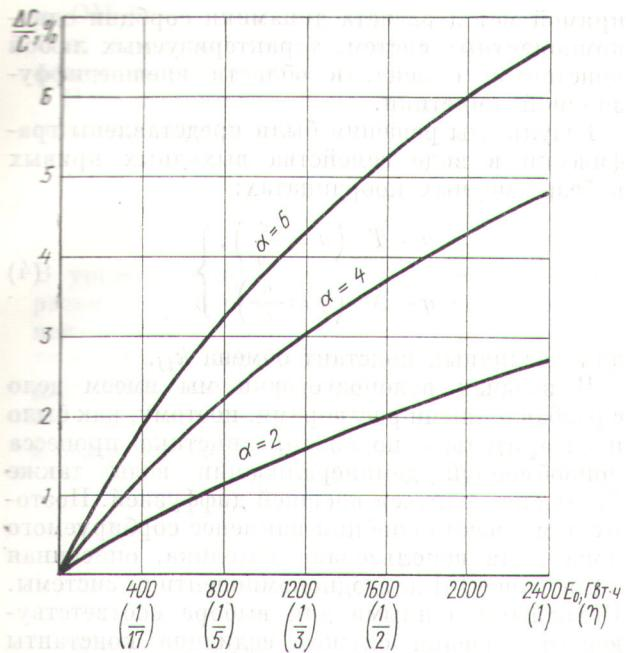
Рис. 4. Относительное уменьшение себестоимости электроэнергии при эксплуатации АЭС с понижением мощности перед перегрузкой (второй случай) в зависимости от выработки энергии между перегрузками при  $N_0 = 200 \text{ МВт}$ ,  $C_T = C_P$  (при соответствующих долях перегружаемых каналов) и  $\alpha$ , равном 6, 4 и  $2 \text{ ГВт}\cdot\text{ч}/\text{МВт}$ .
