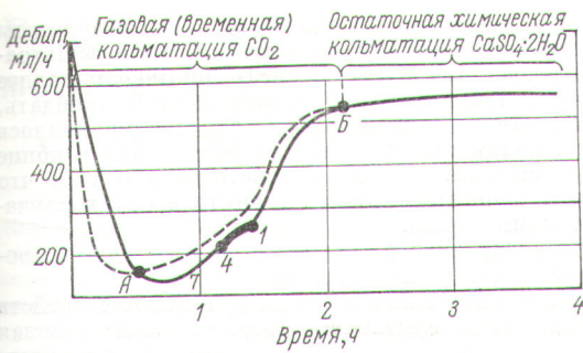
Рис. 1. Влияние химического взаимодействия раствора H_2SO_4 (50 г/л) с карбонатной составляющей песка на его фильтрационные свойства.
