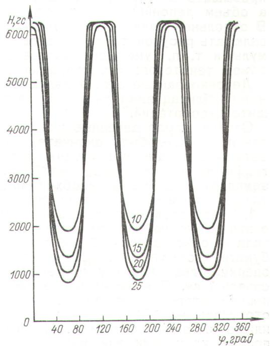
Зависимость магнитного поля от азимута на различных расстояниях от центра (в сантиметрах).
