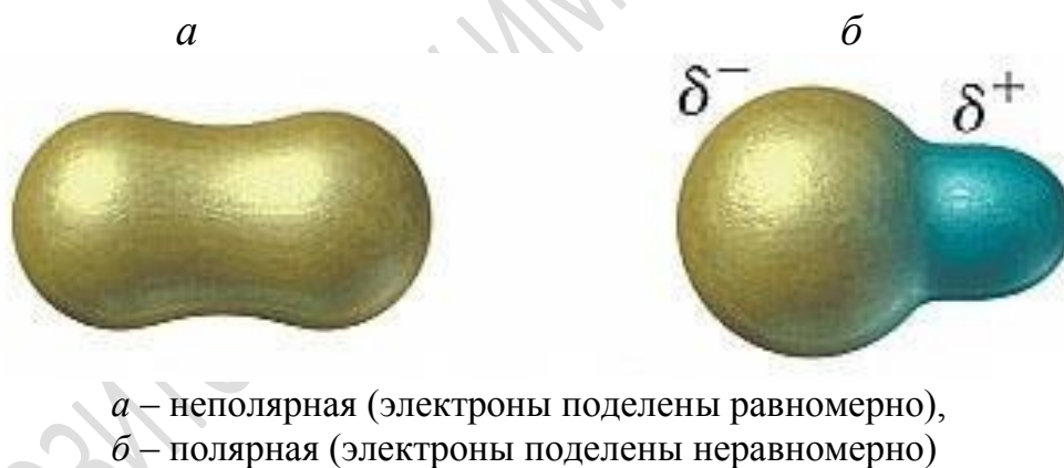
Рисунок 2.4 – Ковалентная связь в твердой компоненте грунтов
