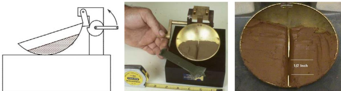
Рисунок 2.58 – Определение влажности верхнего предела пластичности грунта на приборе Казагранде
