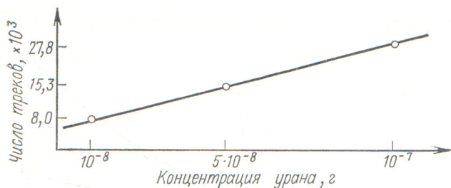
Р и с. 1. Зависимость числа треков от концентрации урана в стандартных образцах.
