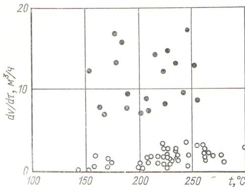
Рис. 1. Влияние вида примеси на скорость забивания индикатора: ● — водород; ○ — кислород.
