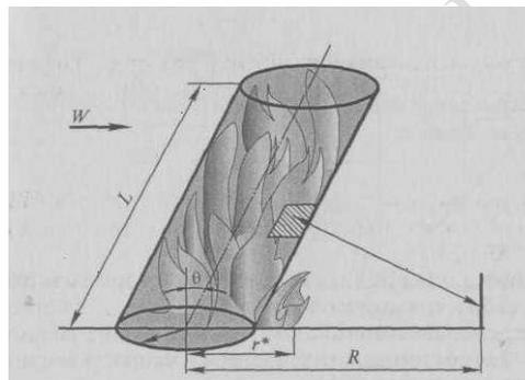
Рисунок 2.1 – Расчетная схема пожара разлития
