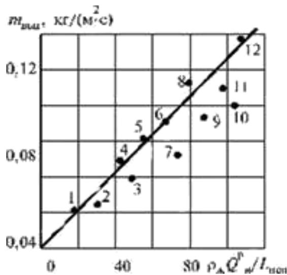
Рисунок 2.2 – Обобщение экспериментальных данных по скорости выгорания различных жидкостей: 1 – метанол; 2 – диэтилен триамин; 3 – ацетон; 4 – диметилгидразин; 5 – ракетное топливо; 6 – ксилол; 7 – бензин; 8 – бензол; 9 – гексан; 10 – бутан; 11 – сжиженный природный газ; 12 – сжиженный нефтяной газ
