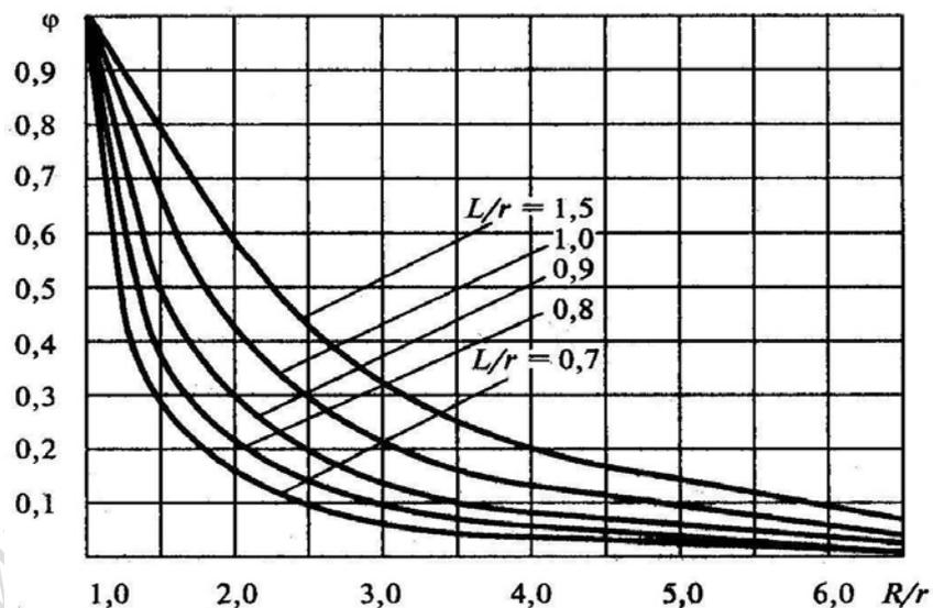
Рисунок 2.3 – Зависимость углового коэффициента излучения  $\phi$  цилиндрического пламени пожара разлития на элементарную площадку от  $R/r$
