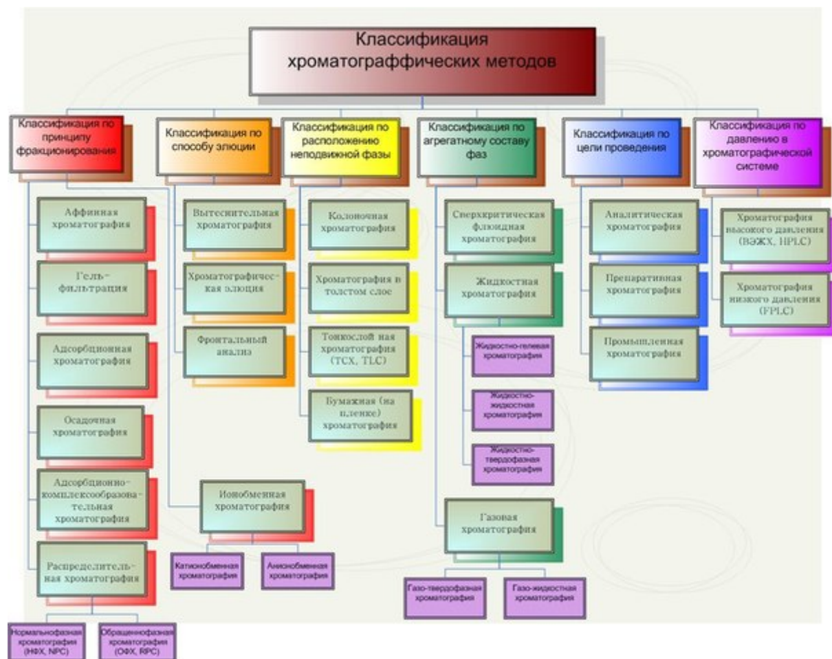
Рисунок 3 – Классификация хроматографических методов
