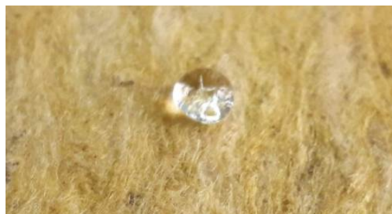
Рисунок 2.2 – Минеральная вата, пропитанная гидрофобизирующей эмульсией
