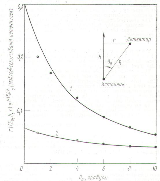
Пространственное распределение интенсивности рассеянного излучения точечного мононаправленного источника в свинце при  $\mu(E_0) R = 4$ ;  $E_0 = 0,279 \text{ MeV}$  (1 — с учетом когерентного рассеяния; 2 — без учета когерентного рассеяния):
