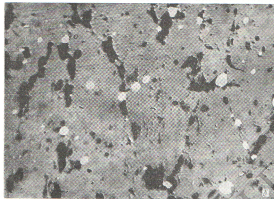
Микроструктура окисного горючего ( \times 400 ): а — образец двуокиси плутония; выгорание 5,3%; б — образец двуокиси урана; выгорание 9,2%.
