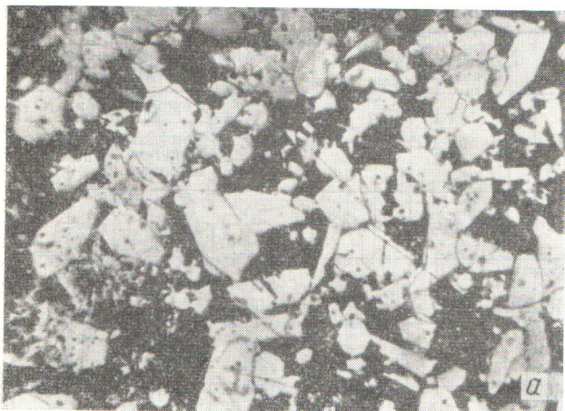
Рис. 2. Скопление кристаллов U_3O_8 - \alpha (светлые) среди тонкозернистого агрегата U_3O_8 - \beta (черный), протравленного азотной кислотой (а, \times 1000 ), и трещиноватые псевдоморфозы UO_{2+x} по U_3O_8 - \beta (б; \times 340 ).
