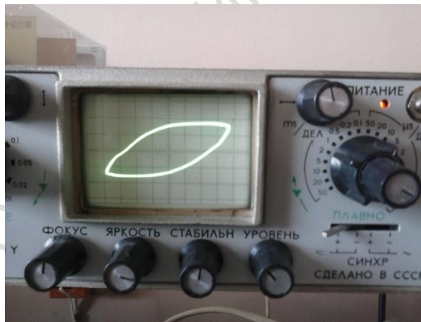
Рисунок 4 – Изображение петли гистерезиса на осциллографе SBT:La 3+ -пленки, синтезированной золь-гель методом
