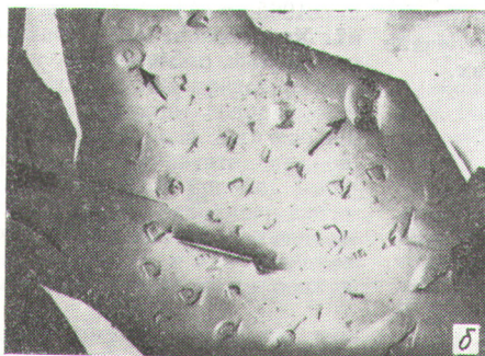
Рис. 1. Скол образца окиси бериллия, облученного интегральным потоком нейтронов 5 \cdot 10^{20} нейтр/см 2 ( \times 10\ 000 ):
