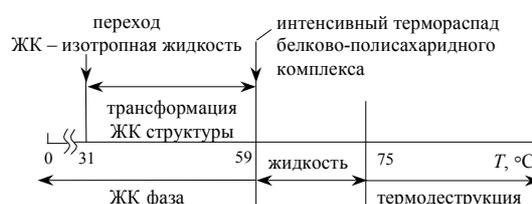
Рисунок 4 – Схема температурных переходов в СЖ
