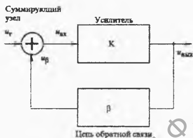
Рисунок 4.15 – Структурная схема усилителя с обратной связью
