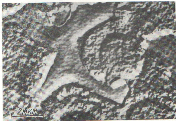
Р и с. 2. Эрозия ванадия, облученного дозой 3,0 \cdot 10^{22} ион \cdot м -2 при 800 К
