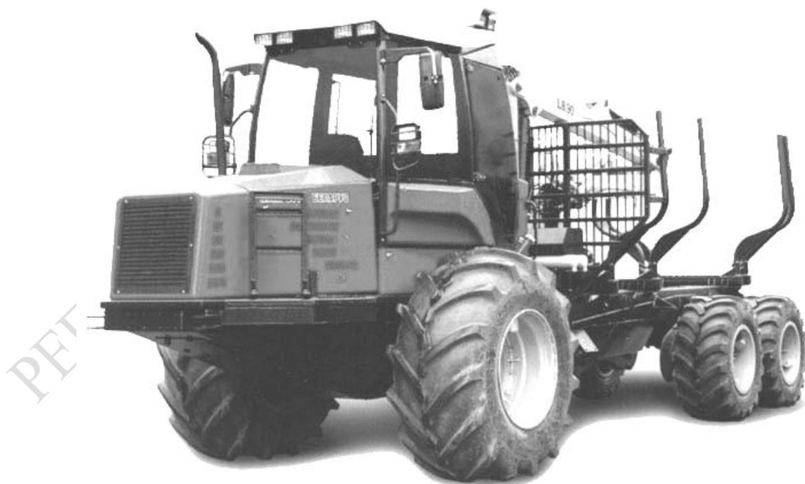
Рисунок 1.3 – Погрузочно-транспортная машина МЛПТ-364 на базе мобильного энергетического средства с шарнирно-сочлененной рамой
