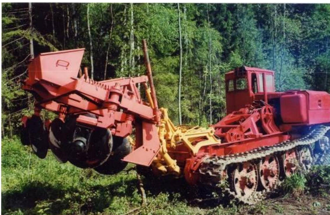
Рисунок 5.10 – Плуг дисковый для вырубков ПДВ-1,5
