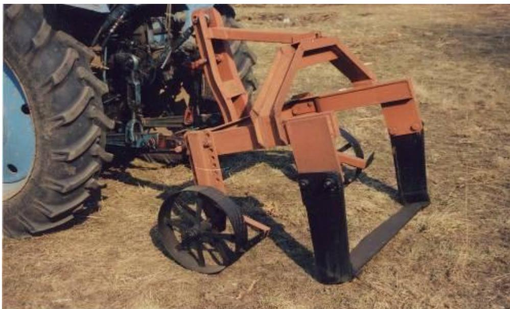
Рисунок 5.25 – Приспособление для подрезки корней ППК-1,2
