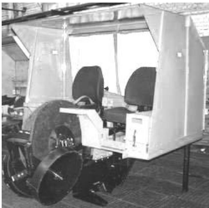
Рисунок 7.5 – Лесопосадочная машина МЛЮ-1А
