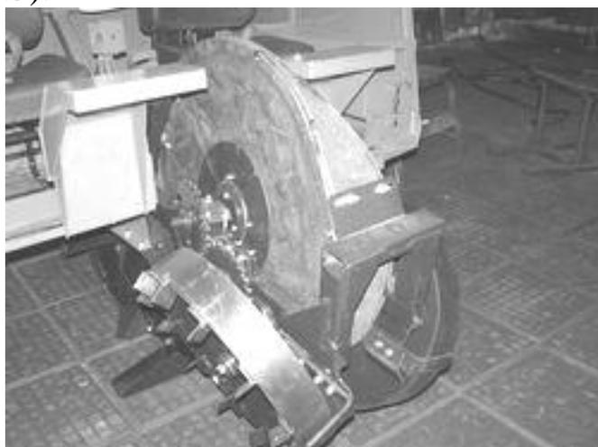
Рисунок 7.3 – Дискковый посадочный аппарат машины МЛУ-1А
