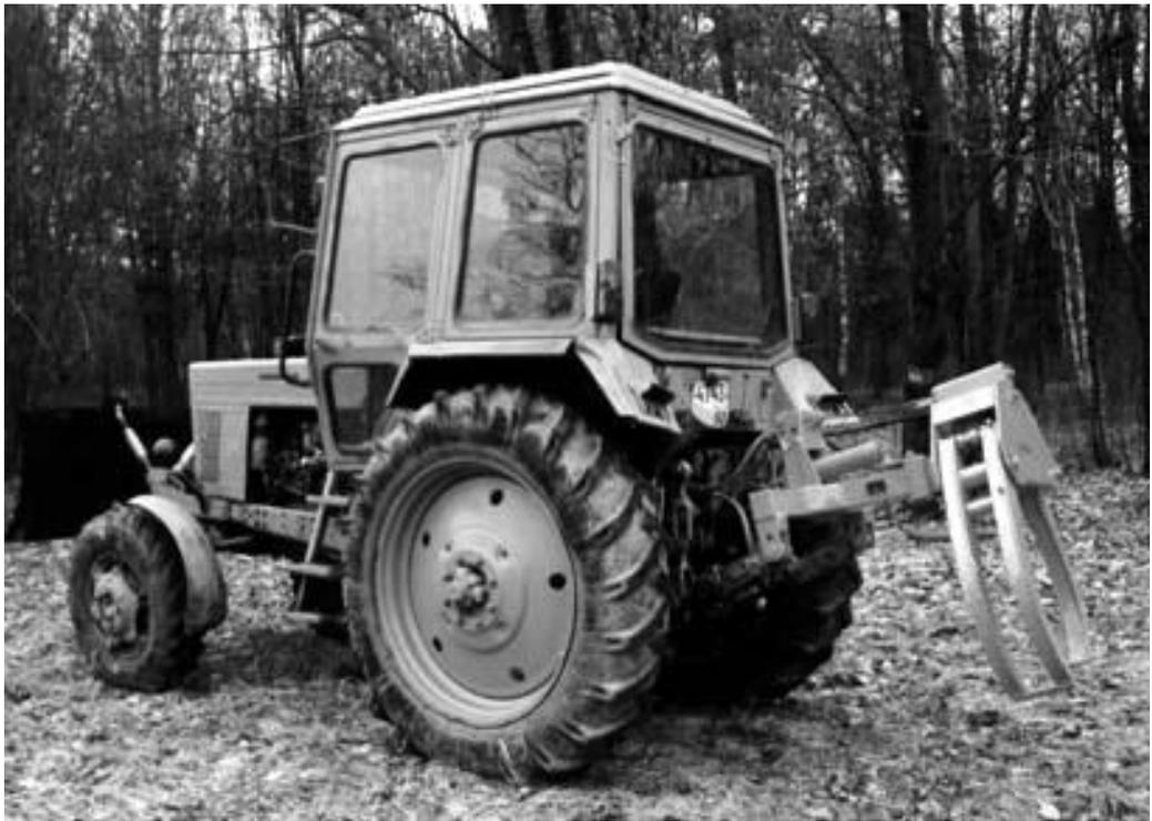
Рисунок 8.14 – Оборудование для рубок ухода ОРУ-2
