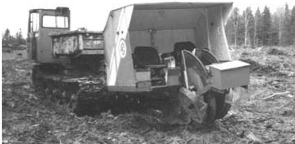
Рисунок 7.7 – Лесопосадочная машина для крупномера МЛК-1
