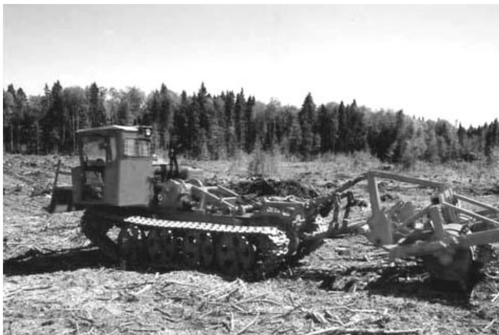
Рисунок 8.9 – Каток-осветлитель КУЛ-2А
