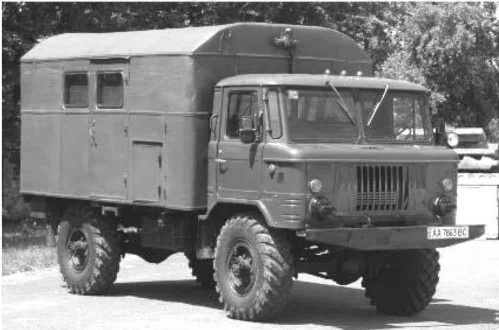
Рисунок 1.6 – Автомобиль ГАЗ-66 для перевозки людей
