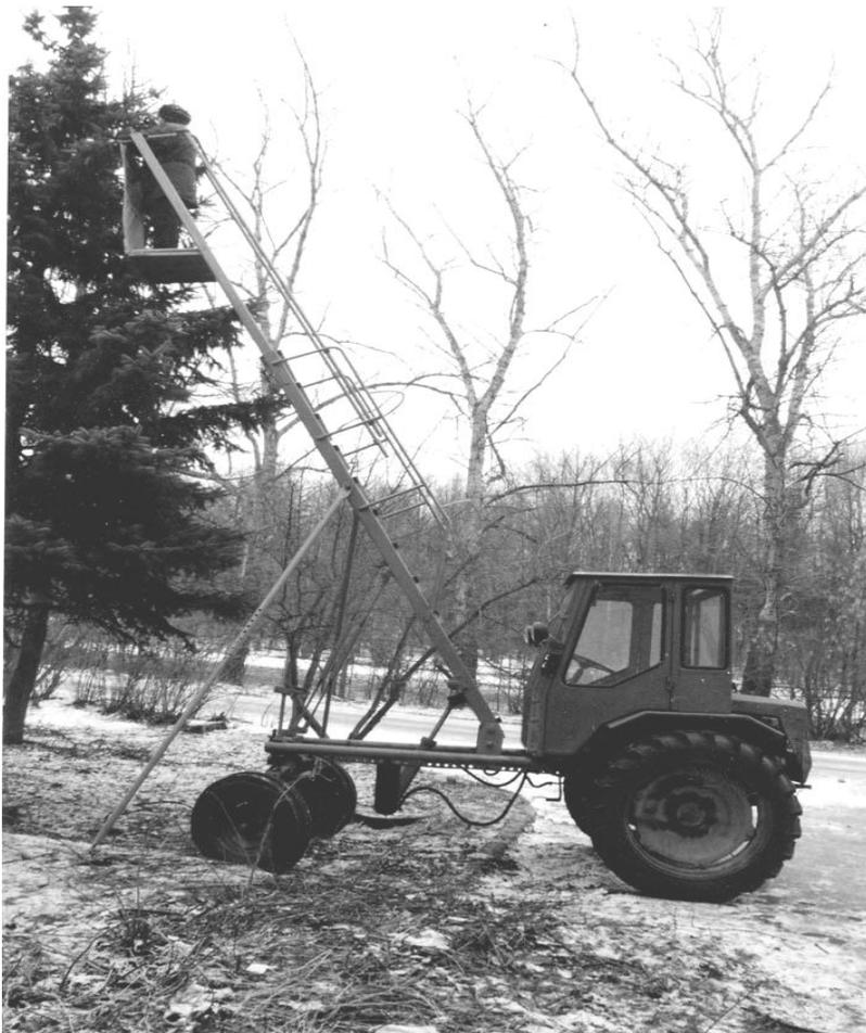
Рисунок 2.9 – Оборудование для сбора шишек ОСШ-1
