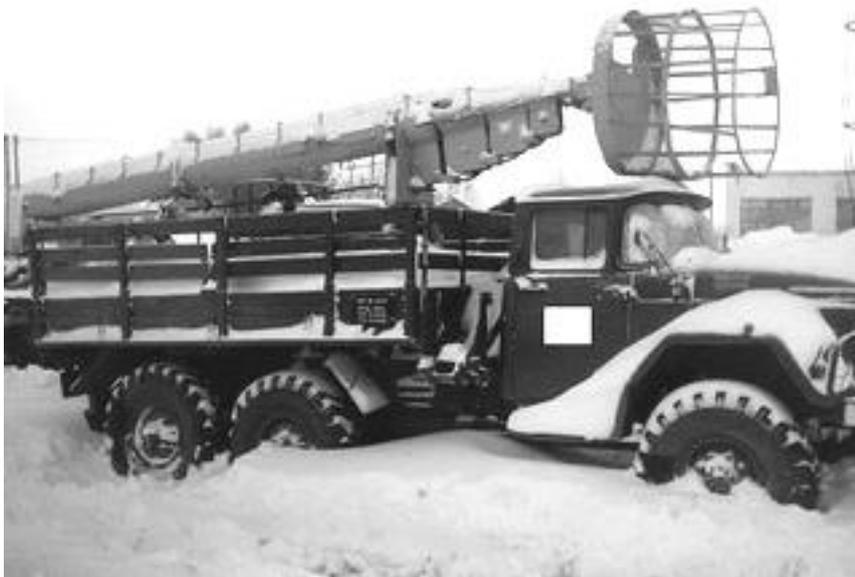
Рисунок 2.4 – Общий вид телескопической вышки ВТ-23
