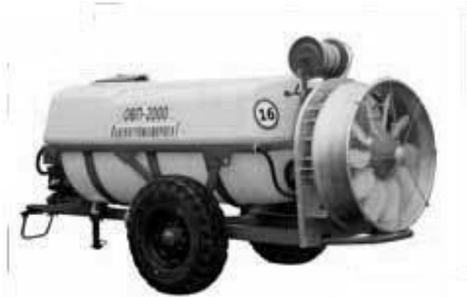
Рисунок 10.4 – Опрыскиватель вентиляторный ОВП-2000
