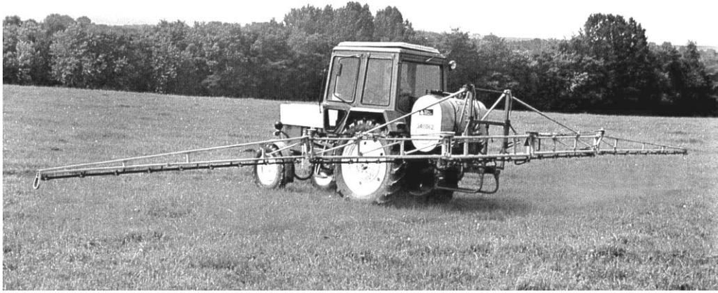
Рисунок 10.3 – Опрыскиватель малообъемный штанговый ОМ-630-2
