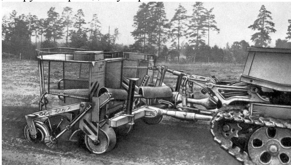
Рисунок 7.8 – Лесопосадочная машина для микроповышений СЛ-2А
