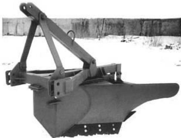
Рисунок 5.7 – Общий вид плуга лесного ПЛ-1
