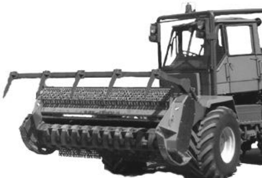
Рисунок 8.7 – Кусторез-измельчитель
