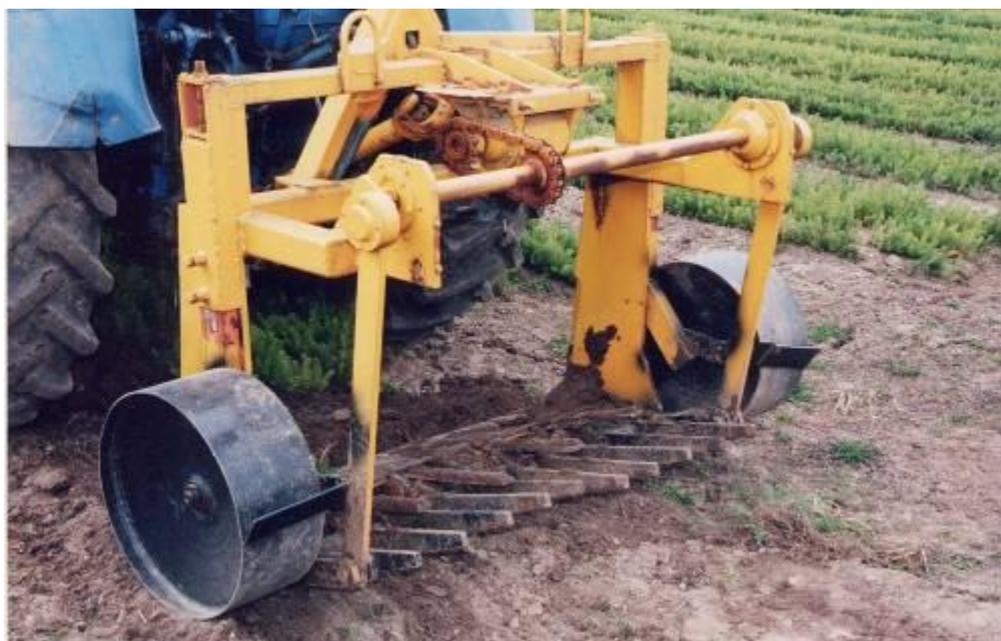
Рисунок 5.26 – Машина выкопчная МВ-1,3
