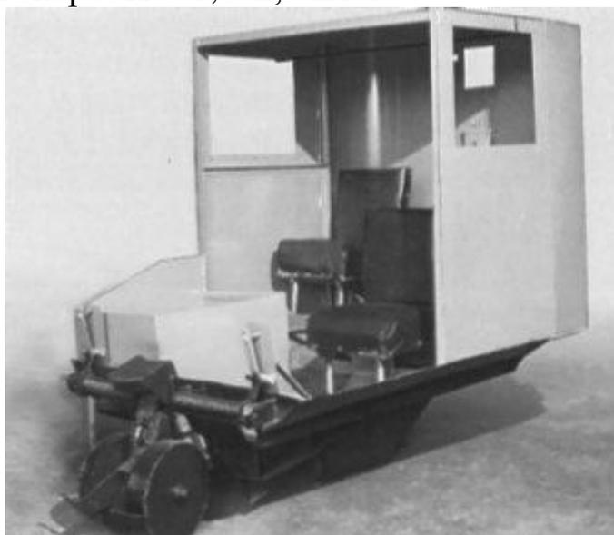
Рисунок 7.6 – Лесопосадочная машина ЛМД-2
