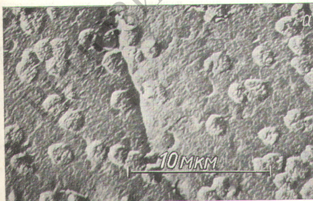
Рис. 2. Поверхность образцов сплава ЦМ10ВД, облученного дозой 1 · 10 18 ион/см 2 (а) и вакуумно-плавленного молибдена марки МЧВП, облученного дозой 5 · 10 19 ион/см 2 (б)
