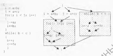
На правом рисунке изображена схема выполнения программы. Операторы, в которые входит несколько стрелок, выполняются только после того, как все операторы, из которых эти стрелки выходят закончили работать. Заштрихованными прямоугольниками выделены операторы, которые сами содержат блоки операторов.
