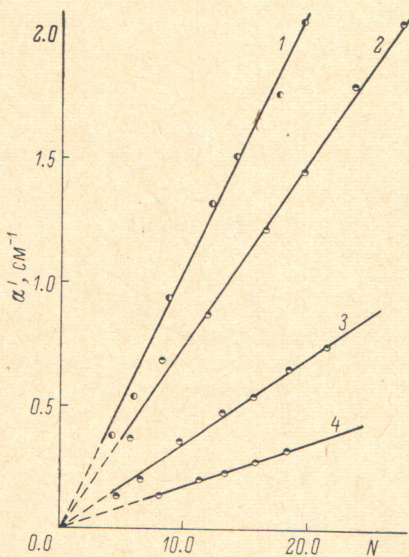
Рис. 4. Зависимость коэффициента ослабления кратно-рассеянного света \alpha' от среднего числа актов рассеяния N (латекс № 2).
