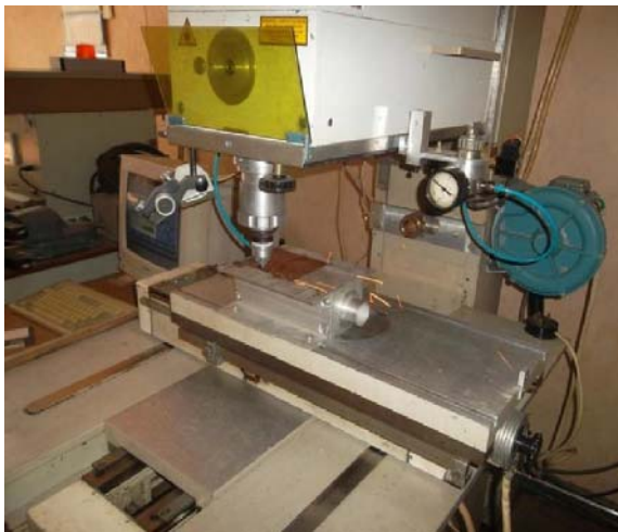
Рисунок 1.1 – Процесс вырезания лазером YAG маски из пластины нержавеющей стали 08X18H10
