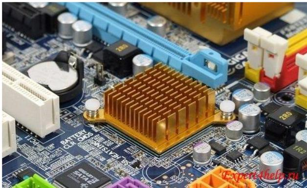
**Пассивной системой охлаждения** считается система, не имеющая механических движущихся частей и не требующая внешних источников питания. Отвод избыточного тепла в таких системах охлаждения, осуществляется естественным образом, т.е. конвекцией. Если уровень выделяемого тепла не очень значителен, то можно установить радиатор с достаточной площадью поверхности теплоотвода.
