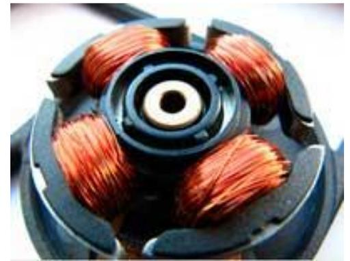
**Вентилятор** состоит из крыльчатки (в ней по внутреннему диаметру расположен магнит) и электромотора, который этот магнит вместе с крыльчаткой вращает. Через центр вентилятора идет осевой штырь, который размещается в центре мотора.
