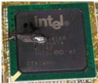
**Короткое замыкание (КЗ)** - электрическое соединение двух точек электрической цепи с различными значениями потенциала, не предусмотренное конструкцией устройства и нарушающее его нормальную работу
