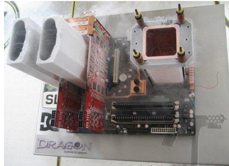
Основными компонентами простейшей системы фреонового охлаждения являются: компрессор, испаритель, конденсер, фильтр, капиллярная трубка. Также необязательным компонентом может быть глазок, ну и хладагент. Все части образуют замкнутый контур, по которому движется.
