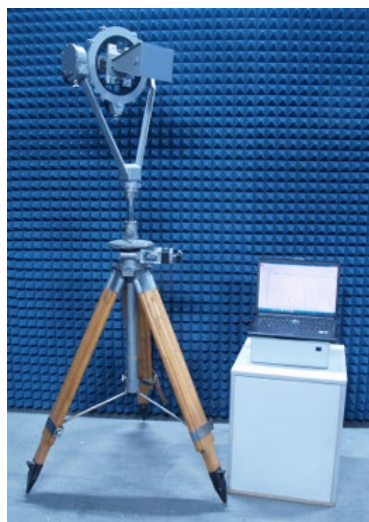
Рисунок 5 – Безэховая камера с блоком управления аппаратно-программного комплекса ЮСТ FarField с портативным компьютером, а также опорно-поворотное устройство с антенной П6-126
