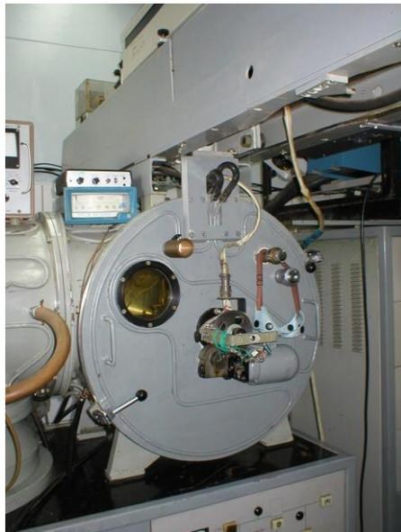
Рисунок 2 – Установка вакуумного напыления УВН-73П-2 оснащенная лазерным и электронно-лучевым испарителями
