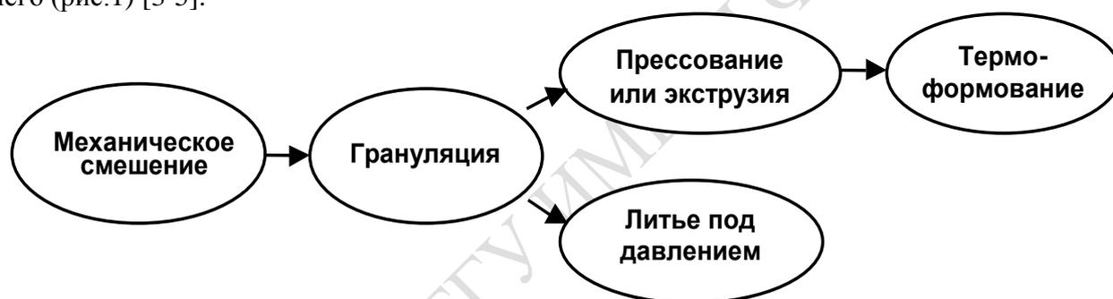
Рисунок 1 – Схема технологических операций производства конструкционных РПМ
