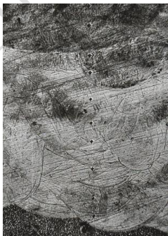
Рисунок 2 – Двухслойная наплавка присадкой (псевдо- \alpha -сплав + ВТЗ-1)
