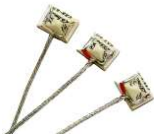
Рисунок 4 – Акустические излучатели ультразвука на основе срезов кварца
