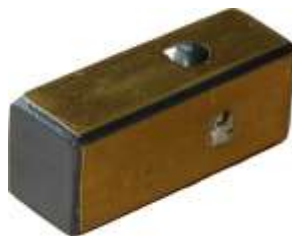
Рисунок 3 – Фото акустического волновода с нанесенными проводящими обкладками
