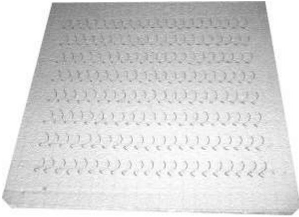
Рисунок 4 – Искусственный образец, содержащий левосторонние одновитковые спирали с углом подъема  $35^{\circ}$
