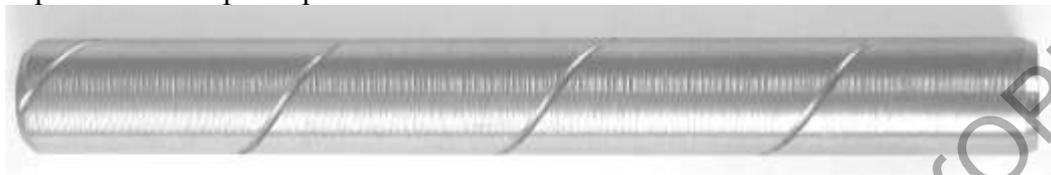
Рисунок 2 – Фотография шаблона для изготовления спиральных элементов
