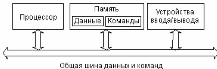
Рис. 1.15. Архитектура с общей шиной данных и команд.
