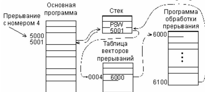
Рис. 3.5. Упрощенный алгоритм обработки прерывания.
