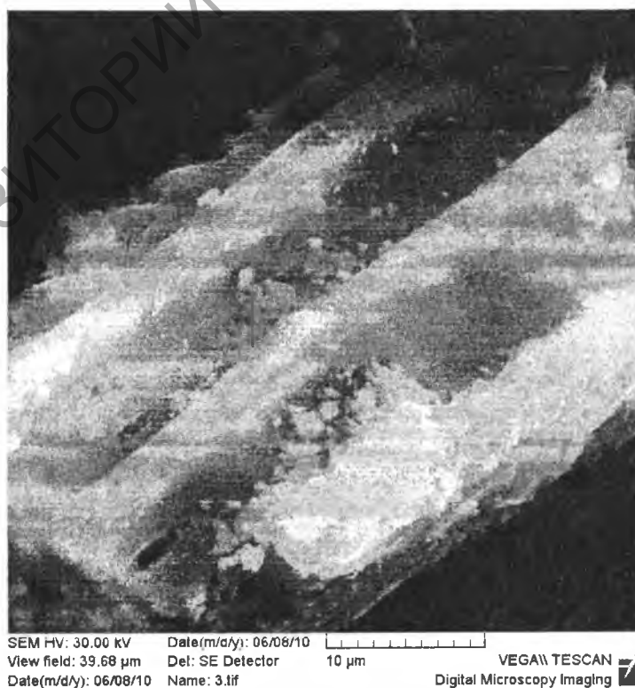
Рисунок 1 – Электронно-микроскопическое изображение фрагмента частицы древесного активированного угля с нанесенным препаратом бинарного ферроцианида
