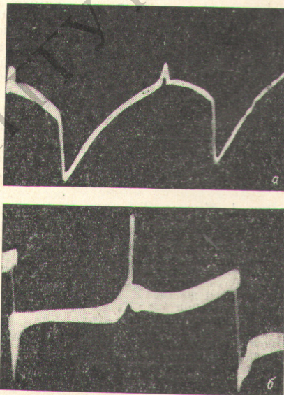
Зависимость выходной мощности He—Ne лазера на \lambda = 3.39 мкм с метановой ячейкой в резонаторе от частоты генерации.
