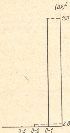
Относительные интенсивности основной полосы и ее первых двух обертонов в ИК спектре молекулы CO.
