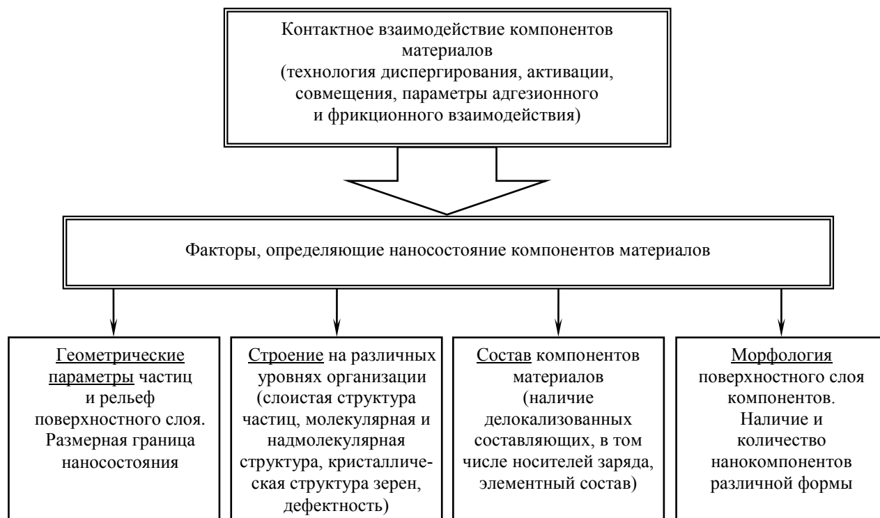
Рисунок 2 — Факторы наносостояния компонентов материальных систем Fig. 2 — Factors of nanostate of components of material systems
