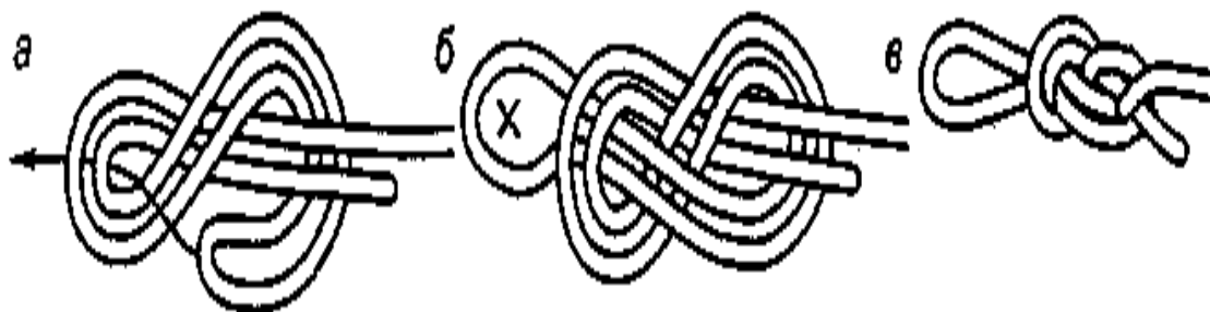
Рисунок 18 – Вязание узла восьмерка
