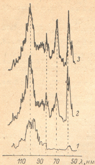
Рис. 1. Спектрограммы европия, записанные при различных энергиях возбуждающих электронов. 1 — 40, 2 — 150, 3 — 300 эВ.
