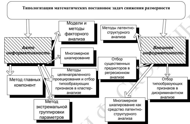
Рисунок 18.1- Типологизация математических постановок задач снижения размерности
