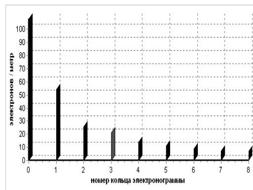
Рис. 2 – Диаграмма распределения электронов в электронограмме
