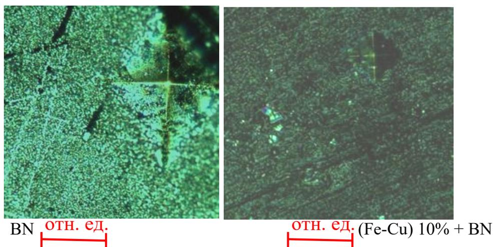
Рисунок 3 – Поверхности композиционного материала с отпечатком алмазной пирамидки
