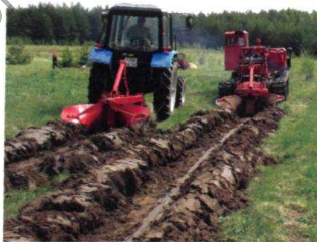
Рисунок 4 – Прокладка минерализованных полос плугами ПКЛ-70 (слева) и ПЛШ-0,4 (справа)
