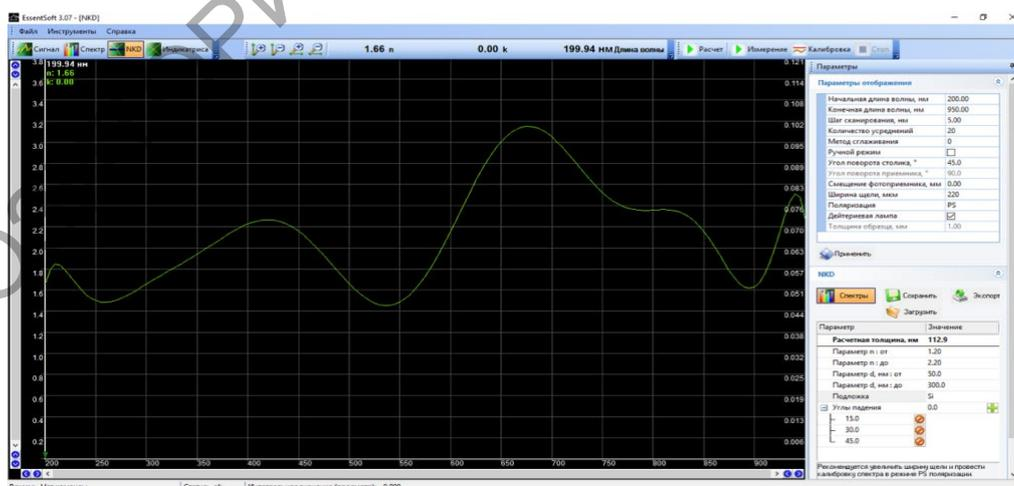
Рисунок 6 – Значение показателя преломления покрытия TiO<sub>2</sub> на длине волны λ=625 нм
