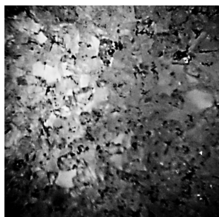
Рисунок 4 – Поровая структура прецизионного шлифовального круга 60 \times 50 \times 25
